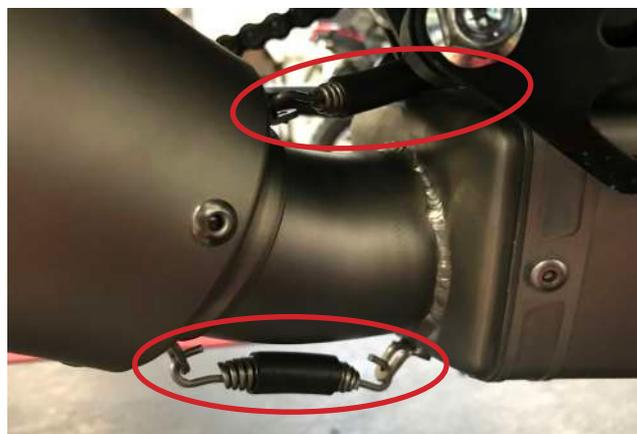
**9. Montare il raccordo, svitare la pedana passeggero per avvitare la staffa telaio sotto di essa. Successivamente inserire il silenziatore ed agganciare le molle**
