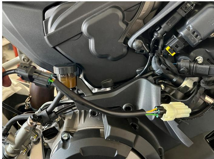
**3. Modificare il passaggio del cavo della sonda in modo da proteggerla da calore e parti in movimento.**
